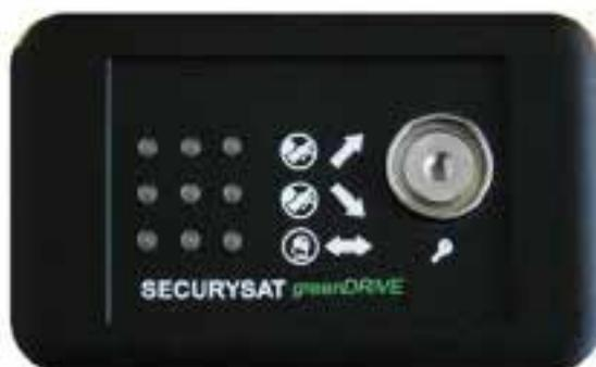
Installé dans le véhicule, Securysat Eco driving enregistre de manière très détaillée de nombreux paramètres : distance parcourue, heure-jour-semaine, type de route empruntée, vitesse, etc.
